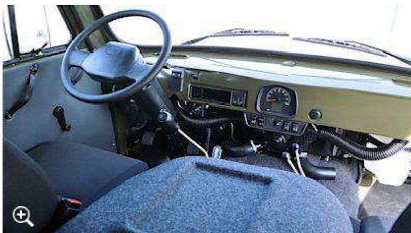
Uprostřed je tachometr, další budíky netřeba. Teploměr vody a palivoměr jsou vyvedeny kostičkami v displeji pod tachometrem.
