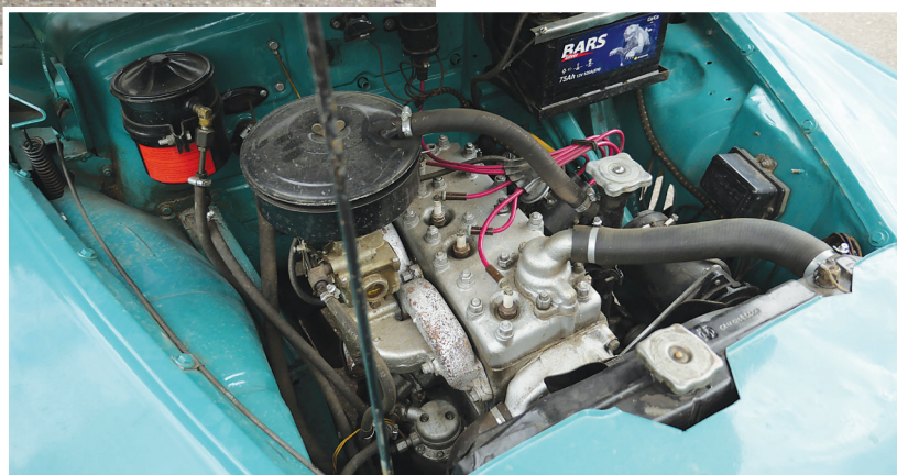
Pod kapotou pracuje zážehová „dvajednička“ s ventily na bocích válců.
