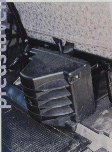
Výměník přídavného topení pro zadní řadu sedadel by si zasloužil vhodnější umístění
