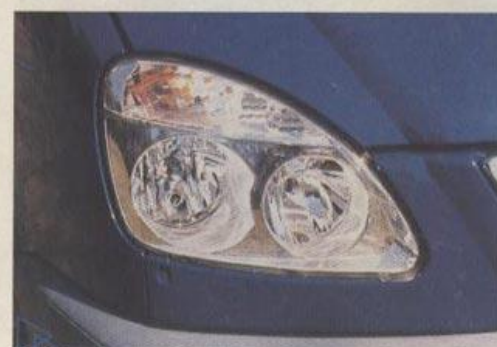
Moderní sdužené světlomety přispívají k příznivé aerodynamice karoserie
