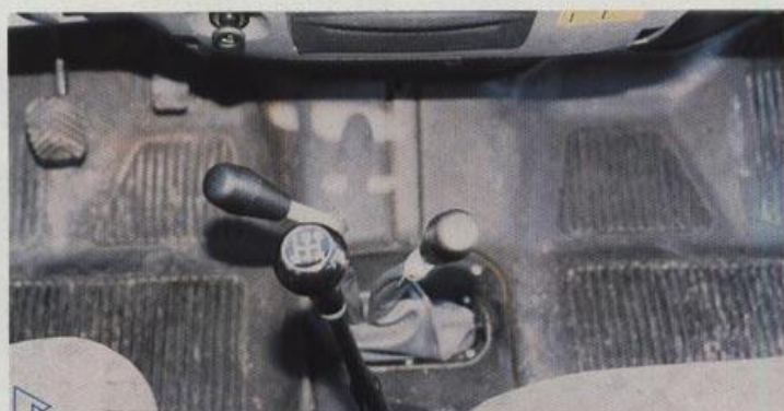
Celkem tři řadicí páky slouží k ovládní jednotlivých převodovek
