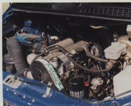
Osvědčený turbodiesel Andoria s mezichladěčem vzduchu má navíc i chlazení oleje
