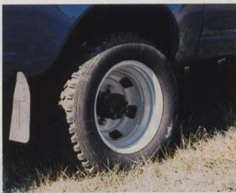
Zadní náprava je vybavena dvoumontáží pneumatik stejného typu jako vpředu
