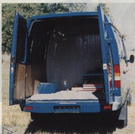
Dvoukřídlové zadní dveře do ložného prostoru lze otevřít až o 180 stupňů
