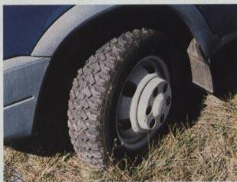
Šestnáctipalcové pneumatiky ruské výroby na plechových discích jsou určeny do terénu
