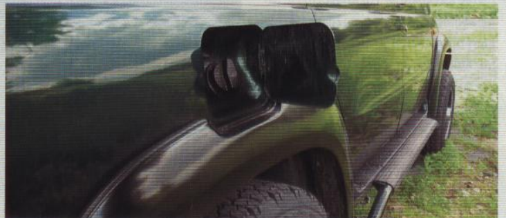
Vzhledem k tomu, že je UAZ vybaven dvěma nádržemi paliva, jsou samozřejmostí vstupní hrdla na obou bocích karoserie
