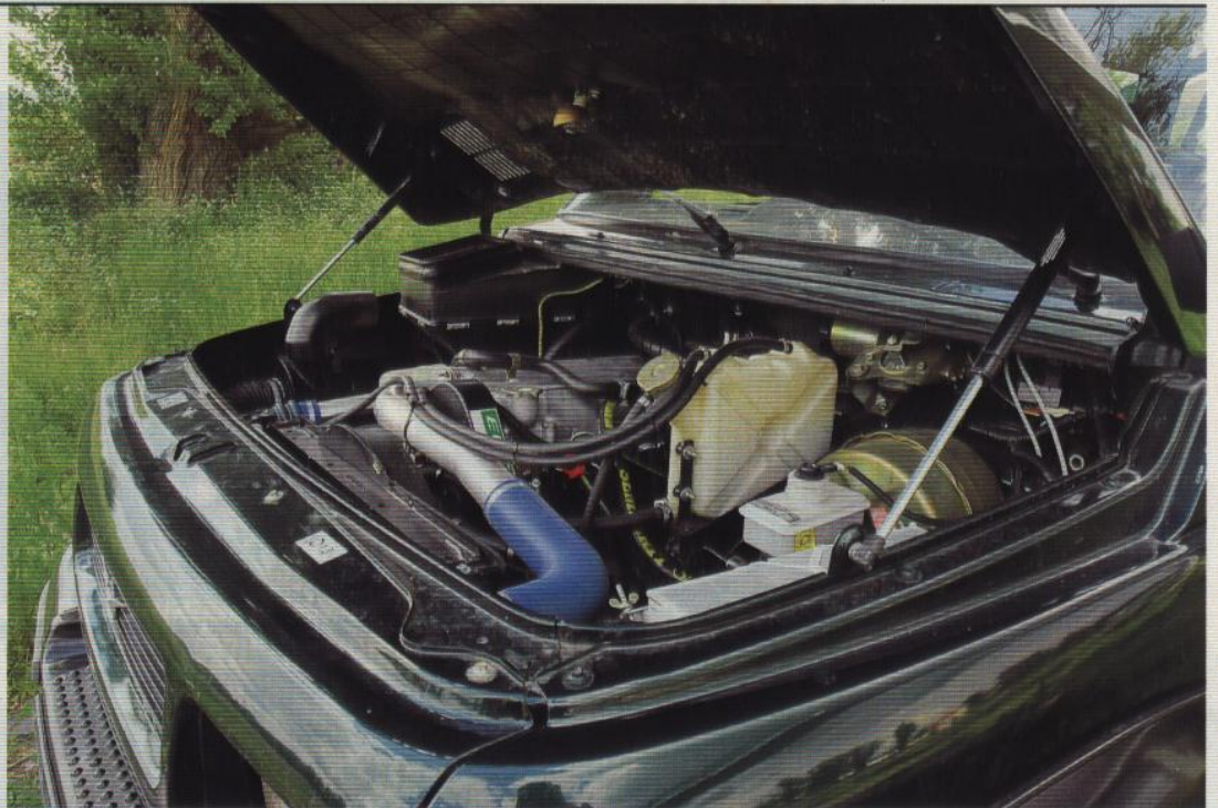
Pod poměrně plochou kapotou na plynových vzpěrách je uložen až překvapivě tichý a pružný čtyřválec Andoria
