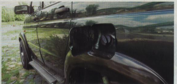
Vzhledem k tomu, že je UAZ vybaven dvěma nádržemi paliva, jsou samozřejmostí vstupní hrdla na obou bocích karoserie
