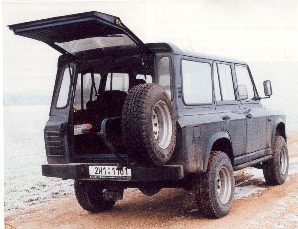
Po otočení rezervy na držáku o 90 stupňů je dobrý přístup do zavazadlového prostoru
