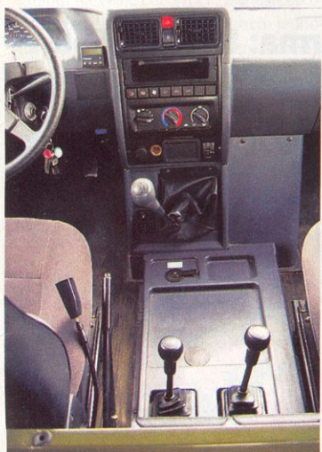
Řidičská páka, přepínač nádrží, páčky redukce a závěru mezinápravového diferenciálu
